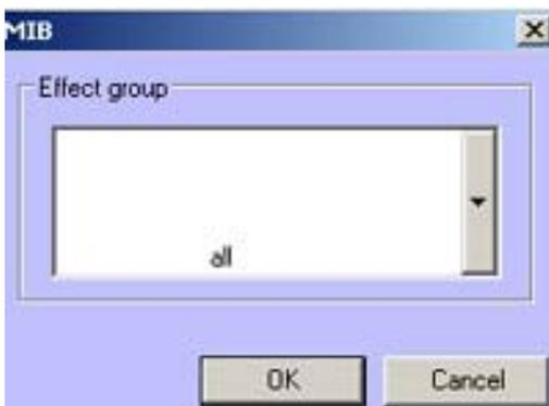
Mit diesem Event lassen sich die in den „Edit DMX-Channel“ aktivierten MIB-Channels mit den entsprechend hinterlegten Werten aufrufen. In dem MIB-Moment haben die MIB-Werte absolute Priorität.
